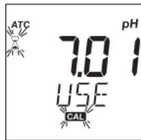
Falls eine Zwei-Punkt-Kalibrierung ausgeführt werden soll, als erstes Puffer pH 7,01 (oder NIST pH 6,86) verwenden.
