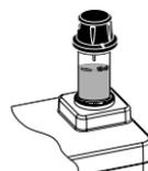
4. **Null** drücken. Das Display zeigt „-0,0-“. Der Nullabgleich ist abgeschlossen und das Gerät ist zur Messung bereit. Küvette aus dem Messschacht nehmen.
