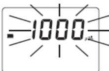
**Über Messbereich:** Wenn der Messwert blinkt zeigt das Gerät an, dass die Konzentration Ihrer Probe über dem Messbereich liegt. Bitte verdünnen Sie Ihre Probe und starten Sie eine neue Messung
