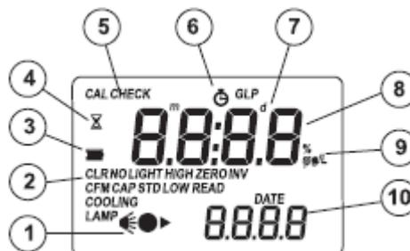
1. Das Messschema (Lampe, Küvette, Detektor), erscheint während verschiedener Phasen im Null oder Messmodus
