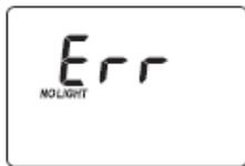
**No Light:** Das Instrument kann die erforderliche Lichtmenge nicht einstellen. Überprüfen Sie, dass die Probe keine Verschmutzungen enthält.
