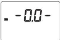
6. Nach einigen Sekunden zeigt das Display „-0.0-“ an. Das Meter ist nun auf null gesetzt und bereit für die Messung
