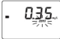
Falls ein Messwert vor der Auto-Abschaltung angezeigt wurde, wird dieser nach dem Neustart wieder angezeigt. Das blinkende „ZERO“ bedeutet, dass das Gerät erneut auf null gesetzt werden muss.
