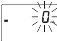
**Unter Messbereich:** eine aufleuchtende „0“ zeigt an, dass die Probe weniger Licht absorbiert als die Null-Referenz. Bitte überprüfen Sie die Prozedur und stellen Sie sicher, dass Sie die gleiche Küvette für die Probe und die Null-Referenz verwenden.
