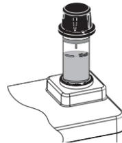
8. **Messen** drücken. Das Display zeigt einen Countdown von 3 Minuten und 30 Sekunden an. Um den Countdown zu umgehen, **Messen** erneut drücken. Nach Ablauf des Countdowns führt das Gerät die Messung aus und zeigt den gemessenen Wert für als **mg/L Ammoniakstickstoff LR (NH<sub>3</sub>-N)** an.
