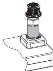
3. Null drücken. Das Display zeigt „-0,0-“. Der Nullabgleich ist abgeschlossen und das Gerät ist zur Messung bereit.
