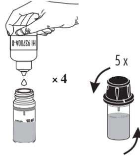
6. 4 Tropfen HI93700B-0 "Reagenz B für Ammonium LR" in die Küvette geben. Kunststoffstopfen und Küvettenkappe aufsetzen. Küvette 5 mal wenden.
