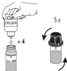
6. 4 Tropfen HI93715B-0 "Reagenz B für Ammonium MR" in die Küvette geben. Kunststoffstopfen und Küvettenkappe aufsetzen. Küvette 5 mal wenden.
