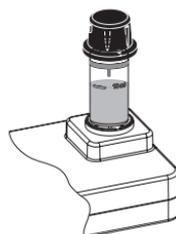
8. **Messen** drücken. Das Display zeigt einen Countdown von 3 Minuten und 30 Sekunden an. Um den Countdown zu umgehen, **Messen** erneut drücken. Nach Ablauf des Countdowns führt das Gerät die Messung aus und zeigt den gemessenen Wert für als mg/L Ammoniakstickstoff ( $\text{NH}_3\text{-N}$ ) an.
