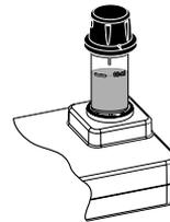
10. **Messen** drücken. Das Gerät führt die Messung aus und zeigt den gemessenen Wert für Hydrazin in  $\mu\text{g/L}$  Hydrazin ( $\text{N}_2\text{H}_4$ ) an.
