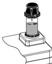
9. **Messen** drücken. Das Display zeigt einen Countdown von 3 Minuten an. Um den Countdown zu umgehen, **Messen** erneut drücken. Nach Ablauf des Countdowns führt das Gerät die Messung aus und zeigt den gemessenen Wert für als mg/L Phosphat ( $\text{PO}_4^{3-}$ ) an.
