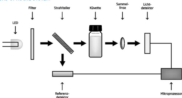
Das interne Referenzsystem des Photometers kompensiert mögliche Drift durch Spannungsschwankungen oder Änderungen der Umgebungstemperatur und bietet eine stabile Lichtquelle.
