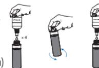
5. 4 Tropfen (Meerwasser: 6 Tropfen) **HI700A-O** Reagenz in die Küvette geben. Küvette mit Stopfen und Kappe verschließen und schwenken.
