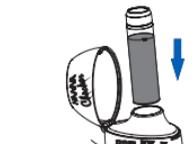
Das Gerät zeigt die Konzentration von Ammoniak-Stickstoff ( $\text{NH}_3\text{-N}$ ) in ppm (mg/L) an. Um den Messwert in ppm Ammoniak ( $\text{NH}_3$ ) umzuwandeln, multiplizieren Sie das Ergebnis mit 1,214. Wenn keine weitere Messung vorgenommen wird, schaltet sich das Gerät automatisch nach 10 Minuten aus.
