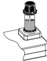
3. **Null** drücken. Das Display zeigt „-0,0-“. Der Nullabgleich ist abgeschlossen und das Gerät ist zur Messung bereit. Küvette aus dem Messschacht nehmen.
