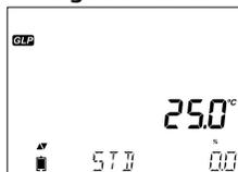
Die GLP-Daten werden automatisch nach dem erfolgreichen Kalibrieren gespeichert. Um die Kalibrierdaten angezeigt zu bekommen, drücken Sie die GLP-Taste, wenn sich das Gerät im Messmodus befindet.
