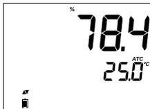
Der Wert des gelösten Sauerstoffes (in %) wird in der ersten Zeile des Displays und die Temperatur in der zweiten Zeile des Displays angezeigt.
