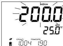
Ist der Messwertbereich automatisch eingestellt und der Messwert liegt außerhalb dieses Bereiches, blinkt der Endwert im Display (200,0  $\text{mS}/\text{cm}$  für ATC-Modus oder 500,0  $\text{mS}/\text{cm}$  für absolute Leitfähigkeit).
