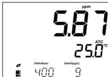
Drücken Sie RANGE um den Anzeigemodus in % bis ppm (mg/l) zu wechseln.
