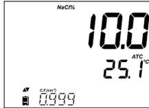
Liegt der Messwert außerhalb des zulässigen Bereiches, wird der Endwert (400,0%) blinkend angezeigt.
