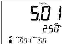
Der Leitfähigkeitswert wird in der ersten, die Temperatur in der zweiten und Kalibrier- und Messbereichsinformationen in der dritten Zeile des Displays angezeigt.
